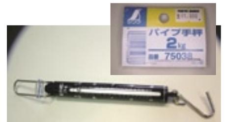
図5：ステントの維持力を計測する手秤。筆者は市販されている安価なものを使用している。
